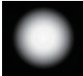
**c** ヘッドライト (光野径：50mm)
